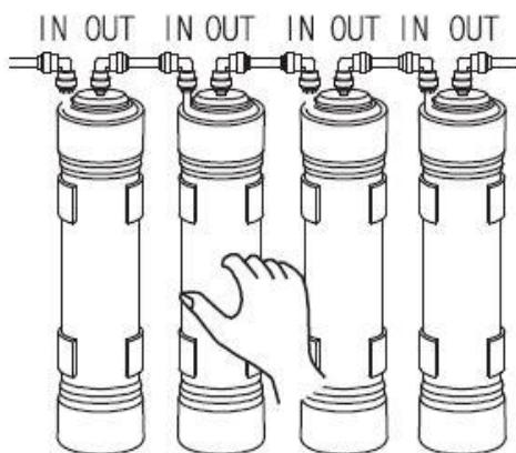
4) После извлечения фильтра снимите с него все подсоединения и замените картридж.
