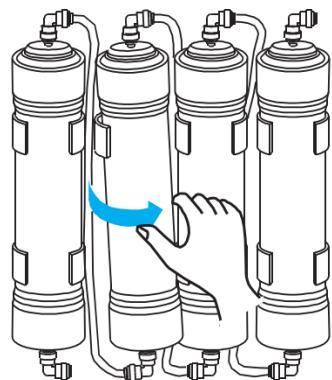
4) После извлечения фильтра снимите с него все подсоединения и замените картридж.
