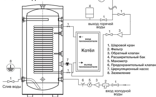
Перед установкой бойлера необходимо тщательно промыть все трубы для удаления посторонних частиц, которые могли попасть в систему отопления или горячего водоснабжения в процессе сборки системы (при нарезке труб, сварке, обработке растворителями).
